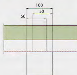
Apoio contínuo de estrutura de outros materiais (tijolos ou blocos):
