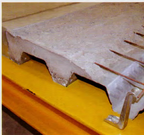
Amostra do Conjunto Final (Note a economia de betão possível de obter, ao optar por esta solução).
